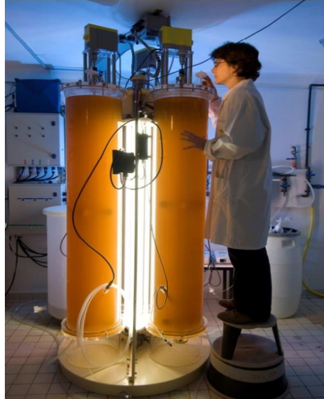
Figure 14: Photobioréacteurs vertical avec éclairage artificiel (Andersen, 2005)
