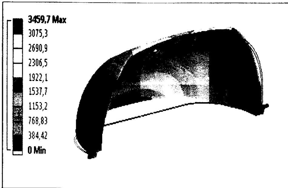
Figure 12: Total déformation (mm)
