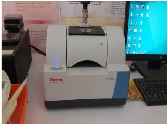
**Appareil Spectromètre THERMO FISHER SCIENTIFIC NICOLET IS5**
