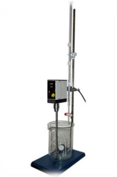
**Figure.II.10 :** Appareillage pour essai au bleu
