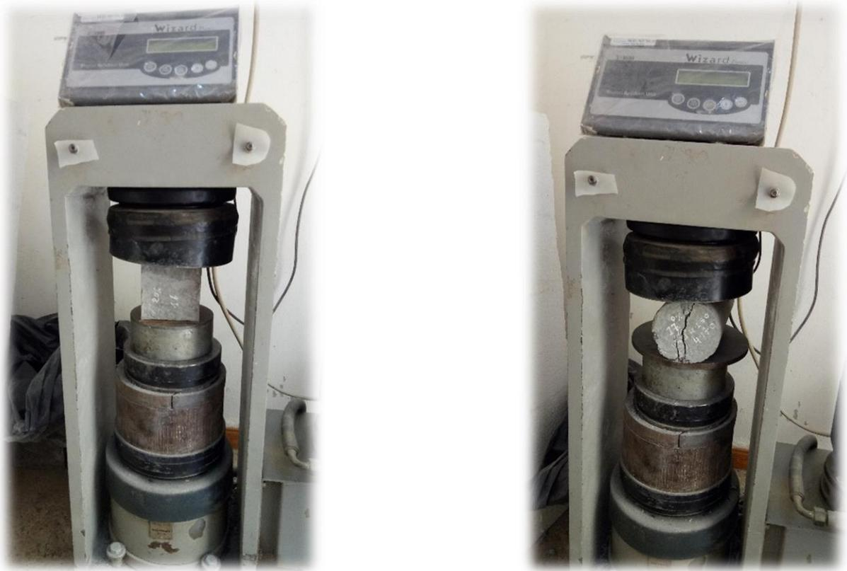
Figure II.13 : Essais de la compression et de traction par fendage
