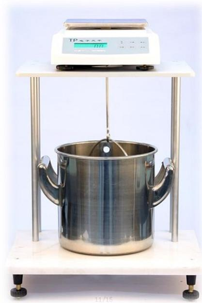
Figure.II.15: Pesé hydrostatique
