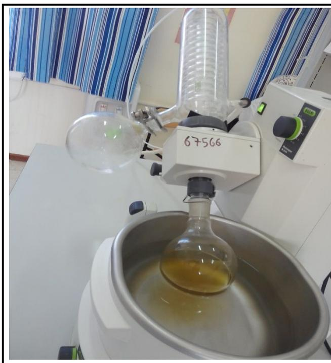
**Figure 20:** Photo représente le phase de séchage par l'évaporateur rotatif (Rotavapor R.210/215).
