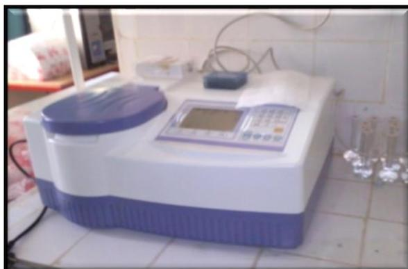
**Photo (IV.4) :** Spectrophotomètre UV-visible utilisé pour le dosage des nitrates.
