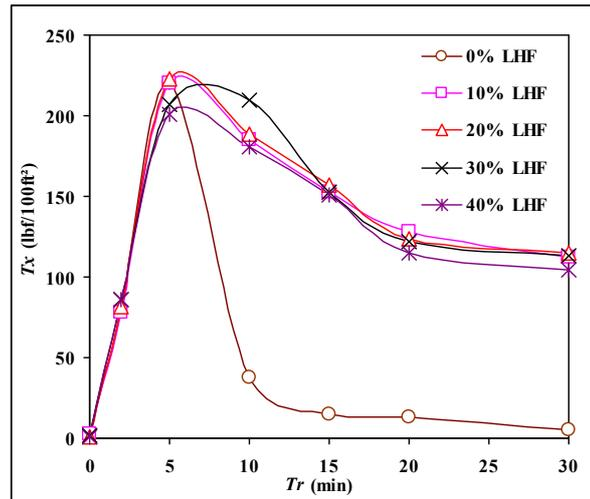
**Fig.3.** Evolution de la thixotropie en fonction de LHF
