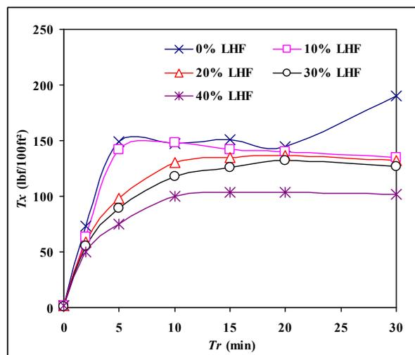
**Fig.4.** Evolution de la thixotropie en fonction de LHF
