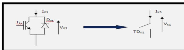
Figure II. 9: Interrupteur bidirectionnel équivalent de la paire Transistor – diode
