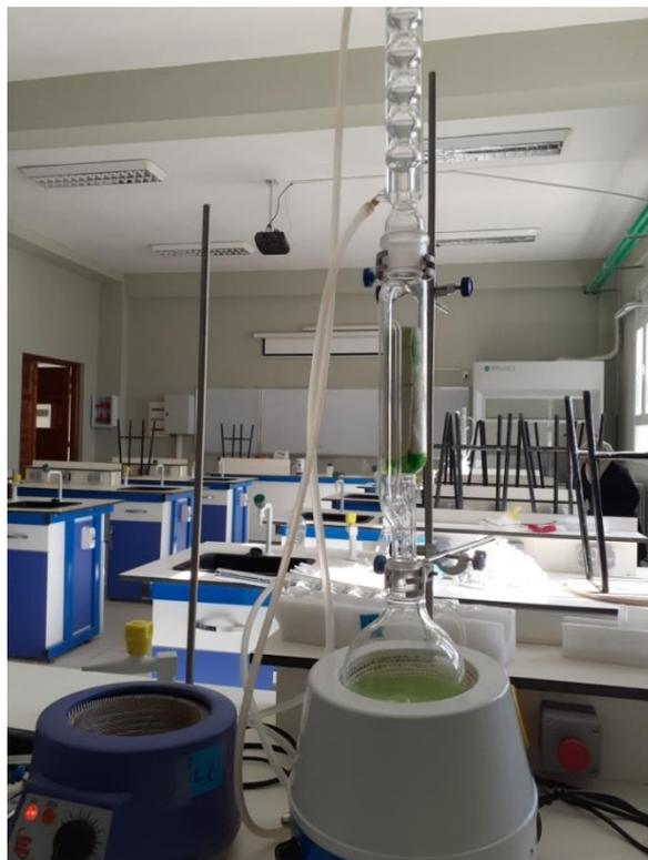
الوثيقة (13): جهاز السوكسلي Soxhlet المستعمل في الاستخلاص.
