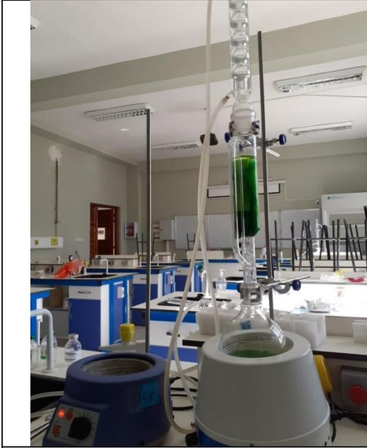
جهاز سوكسلي Soxhlet
