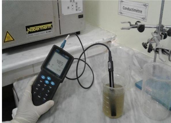
**Fig.17:** Mesure la température et la conductivité par la conductimètre (Photo originale, 2017).
