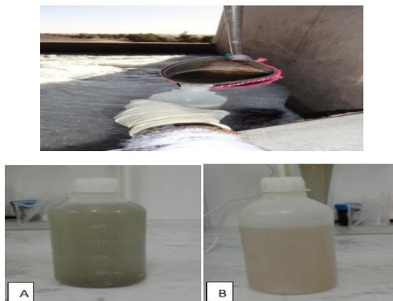
**Fig.16:** Prélèvement d'eau par le tasse de prélèvement (A- L'eau brute, B- L'eau épurée)
