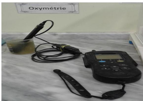
**Fig.19:** Mesure l'oxygène dissous par l'oxymétrie (Photo originale, 2017).
