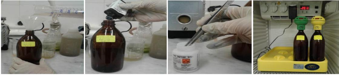
**Fig.21:** Etapes de détermination la DBO<sub>5</sub> (Photo originale, 2017).
