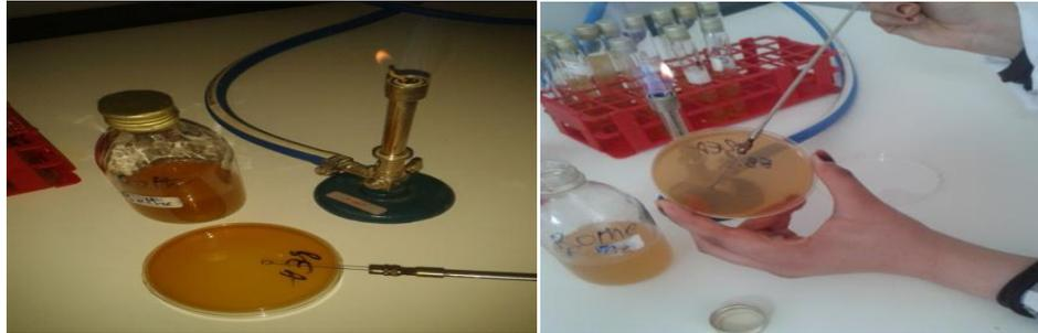
**Fig.26:** Etapes de réalisation de la manipulation de confirmation des streptocoques (**Photo originale, 2017**).
