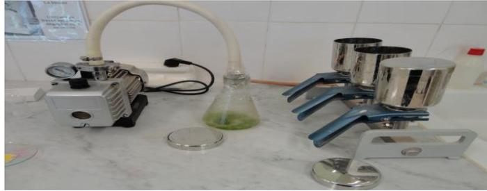
**Figure:** Montage de filtration sous vide (MES d'eau épurée)
