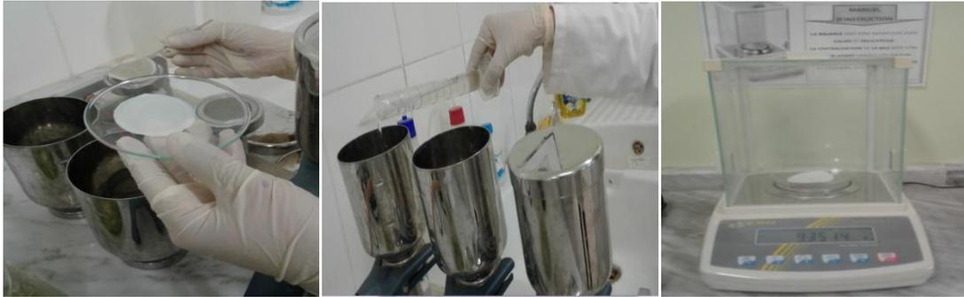
**Fig.22:** Etapes de détermination la teneur en MES d'une eau brute ou une eau traitée (**Photo originale, 2017**).
