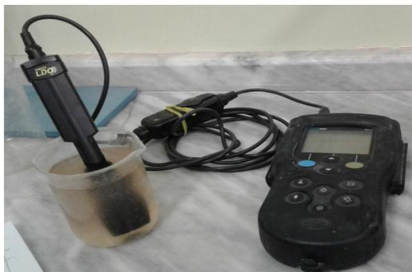
**Fig.18:** Mesure la température et la conductivité par le PH mètre (Photo originale, 2017).
