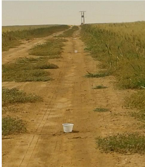
*Figure III.5 : lignes des pluviomètres*
