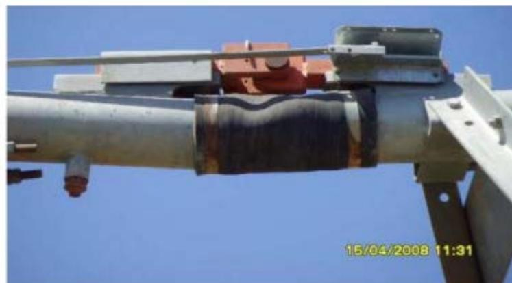
**Figure I.7:** Élément de liaison entre travée, Photo IRRAGRIS.
