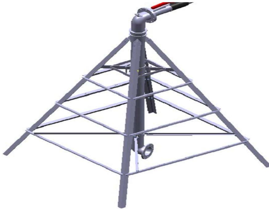
*. Figure I.4. Le pivot d'une rampe pivotante ANABIB*
