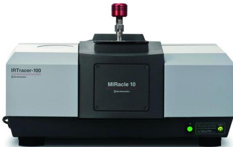
Figure III.2: Appareil de Spectroscopie infrarouge à transformée de Fourier [6]
