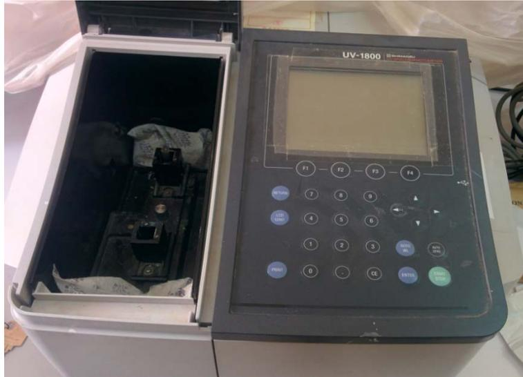
**Figure III.5 :** Dispositif expérimental de la spectroscopie UV-visible utilisé (Université Echahid Hamma Lakhdar, El-Oued)
