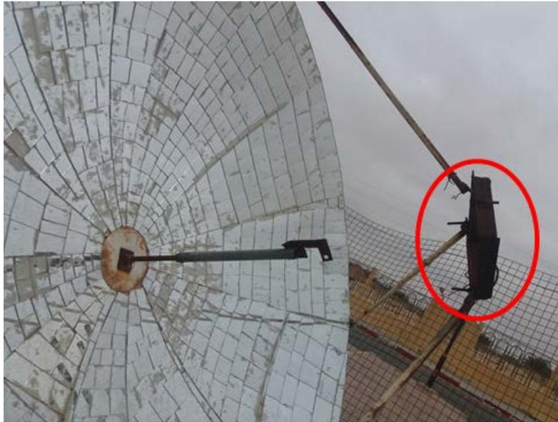
**Figure I.12 :** *Photo du foyer de l'absorbeur*
