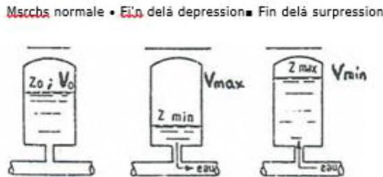
Figure IV-9: Calcul simplifi d'un rservoir d'air
