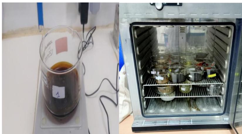
**Figure19.** les extraits dans un cristalliseur dans l'étuve de dessiccation(photo original)
