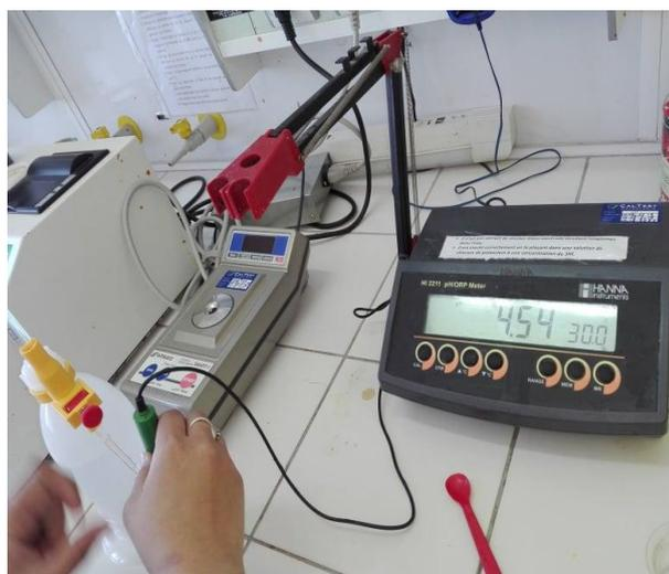
Figure 20:Appareil de mesure du pH
