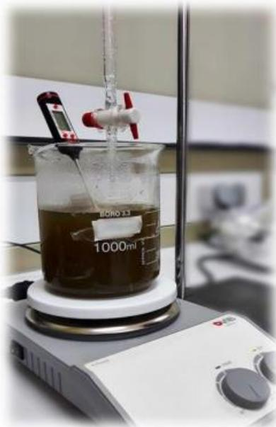
3. Mélanger Solution aqueuse d'Zn\_Se et extrait aqueuse de feuille sous agitation magnétique pendant 1h à une température de 60°C la couleur de la solution est changée du vert clair
