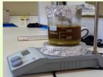
**6. Mélanger sous agitation magnétique pendant 45 min à une température 80°C**
