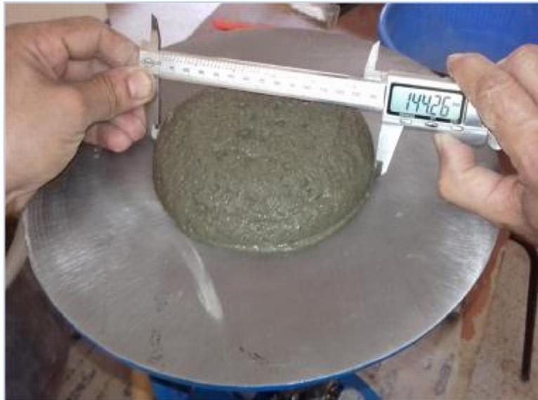
b) Mesure de l'étalement (Pied à coulisse digital 1/100 mm)
