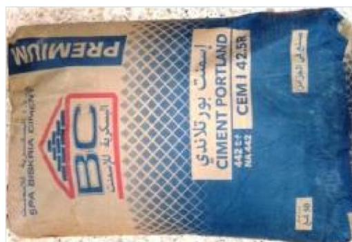
Figure II. 1: Sac de ciment utilisé (CEM I 42.5R - Biskria)
