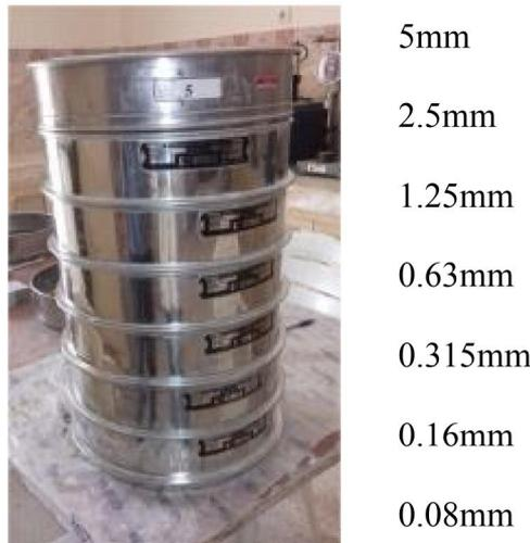
**Figure II.6:** Série des tamis d'analyse du sable
