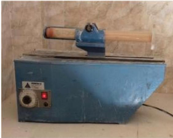
a) Agitation de l'éprouvette à 90 cycles en 30s
