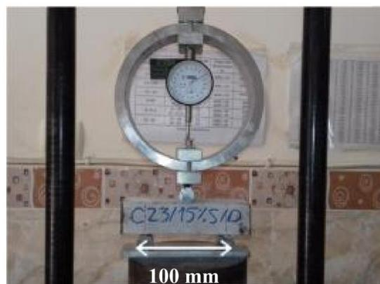
**Figure II.28** : Écrasement d'une éprouvette prismatique ( $40 \times 40 \times 160 \text{ mm}^3$ ) par flexion
