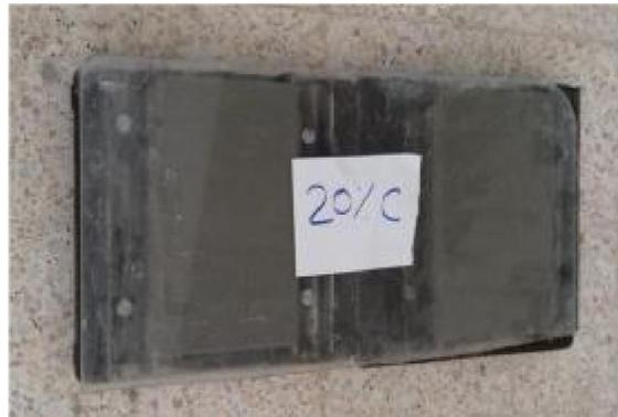
a) Avant démoulage : Couverture des moules par une plaque de verre
