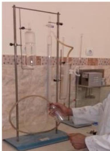
**Figure II.10 :** Exécution de l'essai au Calcimètre Dietrich
