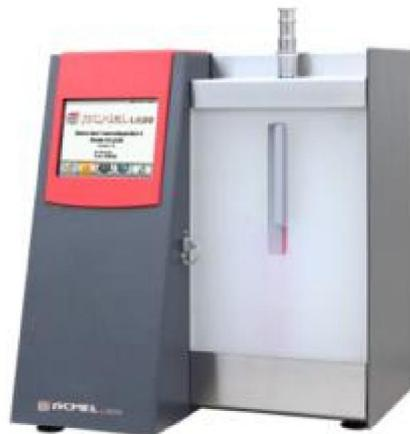
**Figure II.17:** Appareil de Blaine de marque ACME/Laboratoire cimenterie CILAS/Biskra
