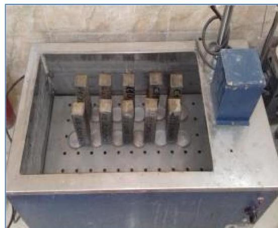
b) Éprouvettes imbibées partiellement selon le schéma de principe
