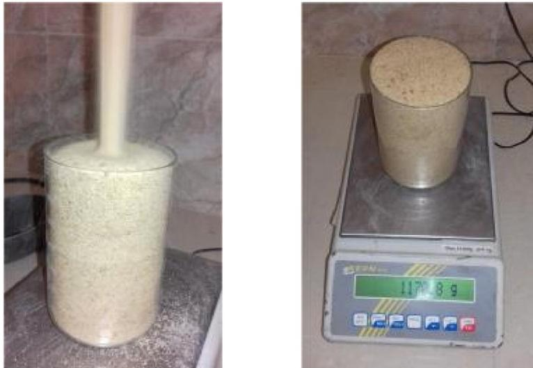
Figure II.8: Mesure de la masse volumique du sable jaune
