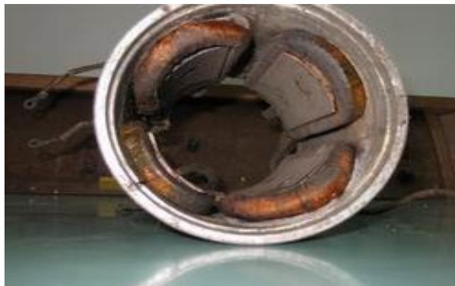
Figure (I.3):Carcasse de moteur à courant continu.
