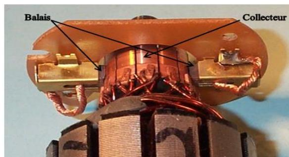
Figure (I.7):Le dispositif collecteur / balais.
