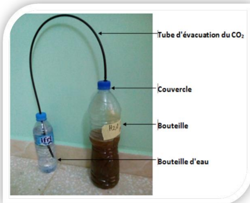
Figure 8 : Dispositif de la fermentation alcoolique (Originale,2017).
