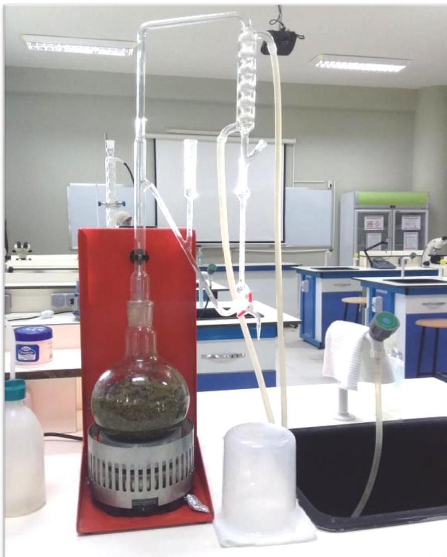
**Figure.17** : Hydro Distillation par Clevenger (photos originales, 2021).
