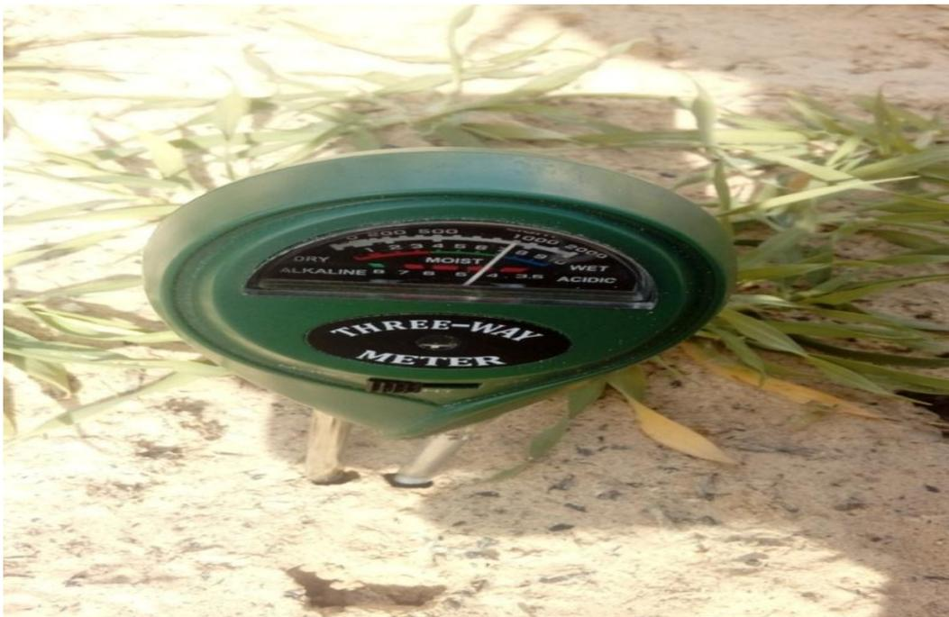
**Figure 16** : Appareil de mesure du pH du sol Original , 15-02-2019
