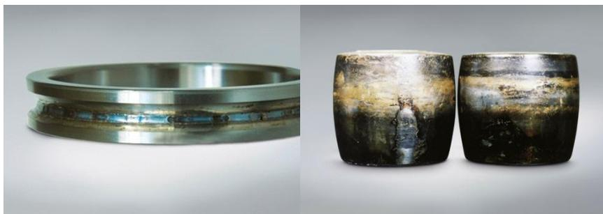
**Figure.II.2.**Grippage sur la bague intérieure d'un roulement [TRO01].
