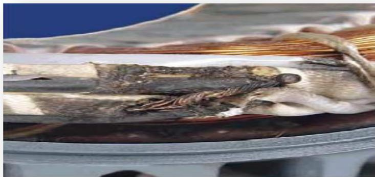
**Figure.I.14.** Défaits d'isolant dans un enroulement [BAB14].
