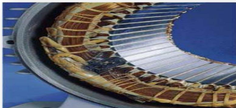
**Figure.I.13.**Court-circuit entre spires dû aux coupures de Tension [BAB14] .
