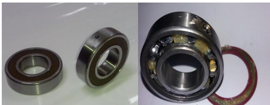
**Figure.III.1.**Photos d'un roulement défectueux dans la BE [BES17] .
