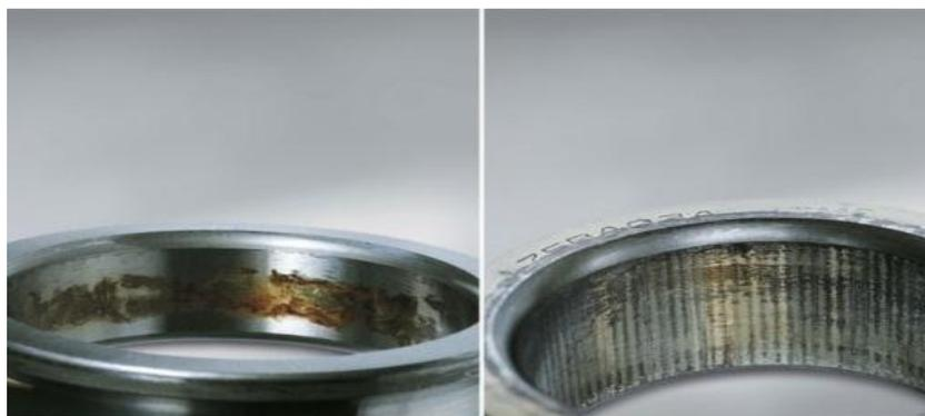
**Figure.II.4.**Corrosion de contact sur la bague Intérieur
