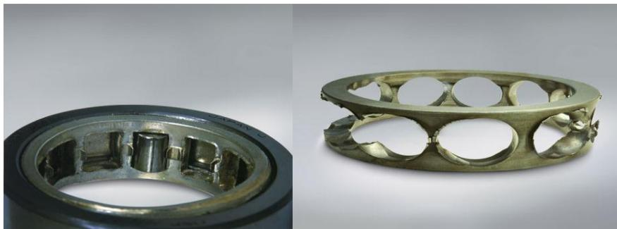
**Figure.II.3.**Déformation de cage d'un roulement [TRO01].
