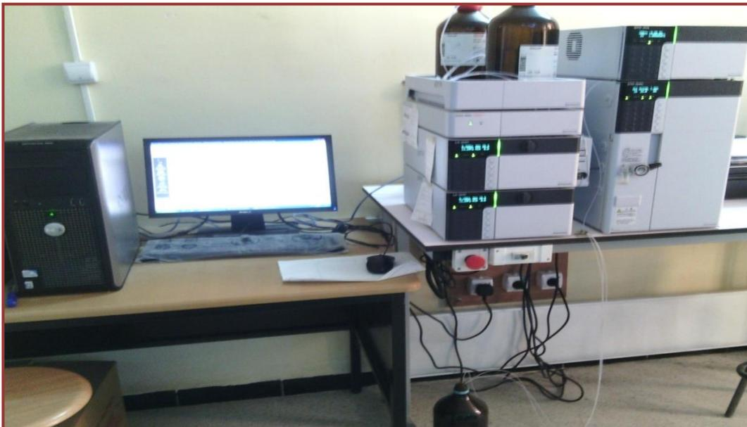
Figure : Chromatographie en phase liquide à haute performance (HPLC) de type SHIMADZU (Photo originale).
