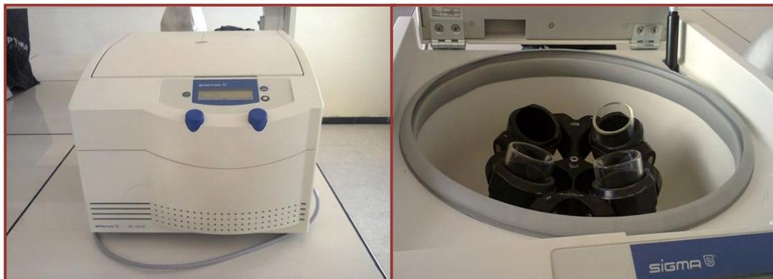
Figure : Centrifugeuse horizontale de type SIGMA (photo originale).
