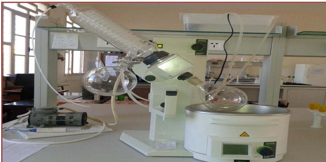
Figure : Evaporateur rotatif de type Büchi Rotavapor R- 200(photo originale).
