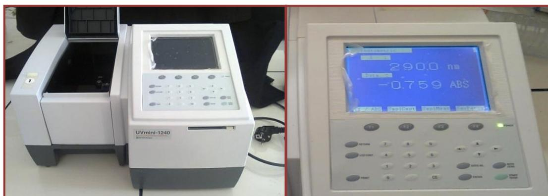
Figure : Spectrophotométrie à transmission moléculaire de type UV- VIS -1240 (photo originale).
