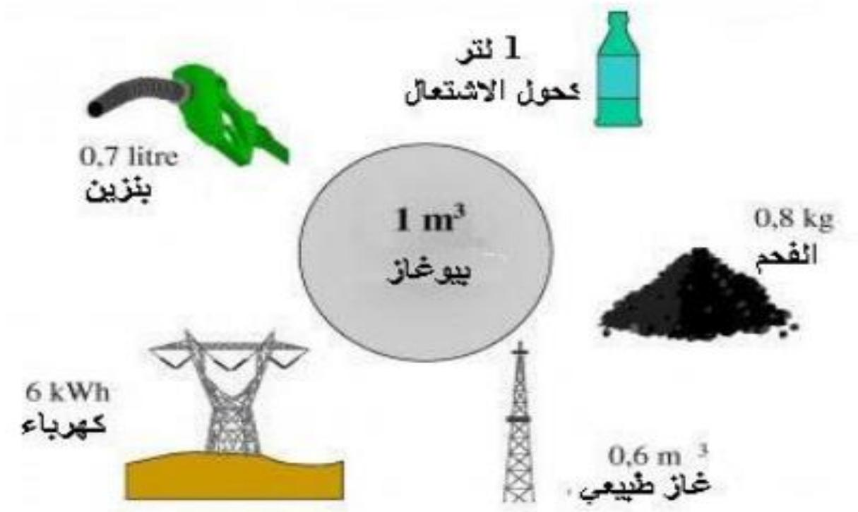
صورة (10): مقارنة بين القيمة الحرارية للغاز الحيوي و أنواع الوقود التقليدية (ويكيبيديا. 2018)
