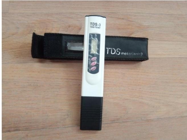
صورة (20): جهاز قياس الملوحة
