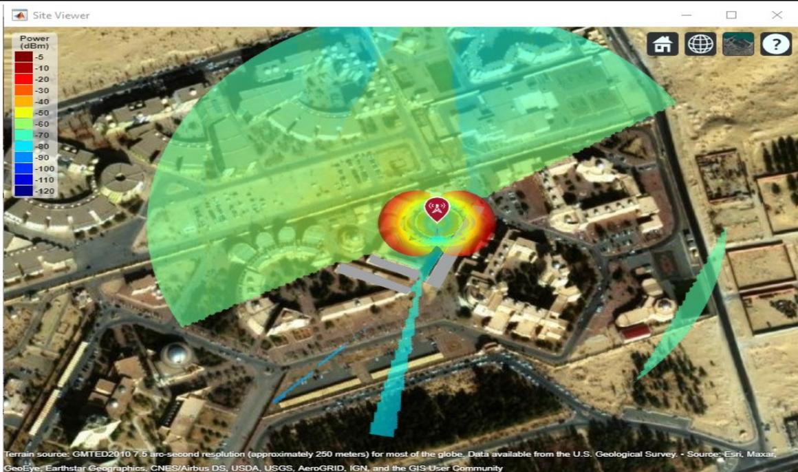
Figure 3.7: Zone couverte par l'émetteur.
