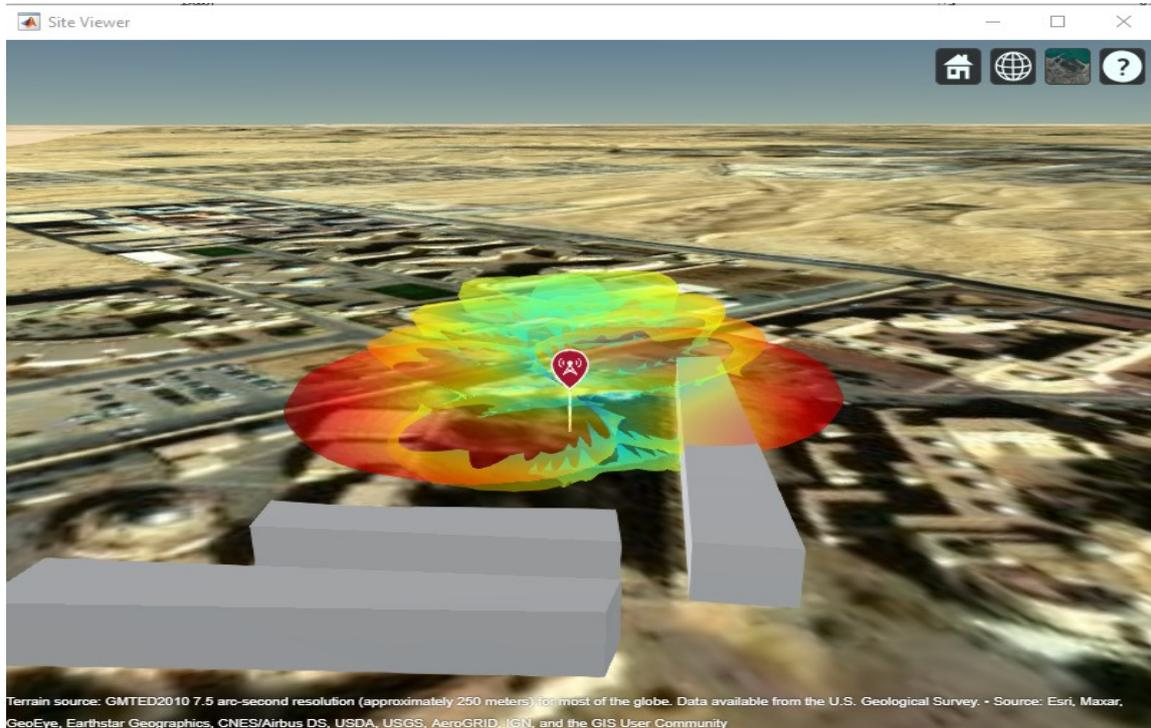
Figure 3.6: Couverture de l'antenne sur une carte de terrain en 3D
