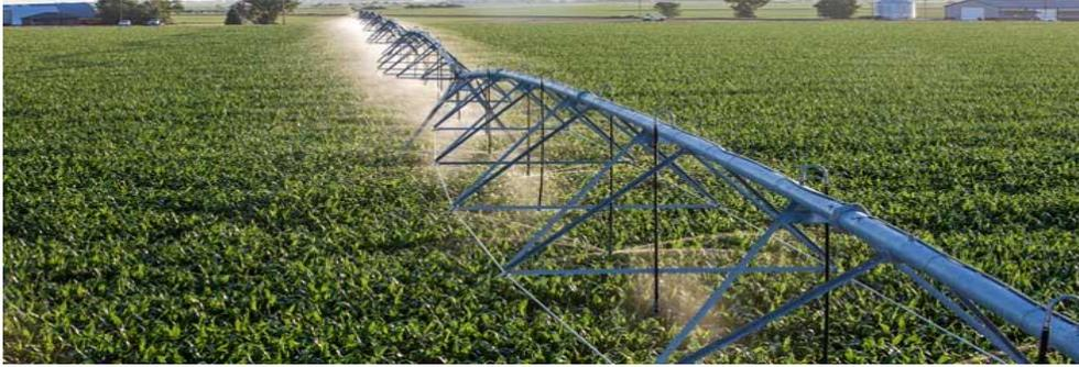
**Figure I.4 :** Travées d'une rampe pivotante.
