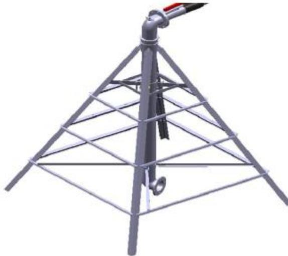
**Figure I.3** : L'élément central (appelé aussi axe ou pivot)
