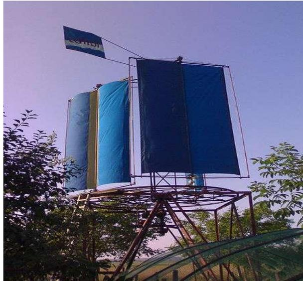
Figure.1.6 Éolienne à axe vertical et à voilure tournante
