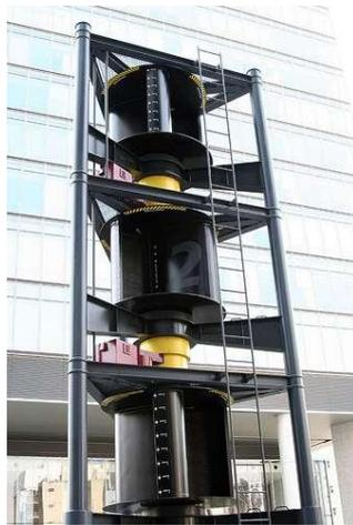
**Figure.1.4 : Éolienne à axe vertical de type Savonius**
