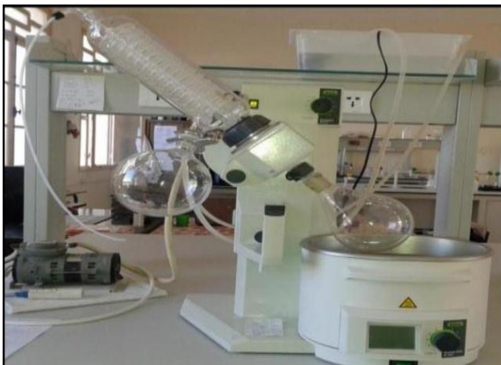
**Figure:** Évaporateur rotatif de type Büchi Rotavapor R-200 (photo originale, 2018)
