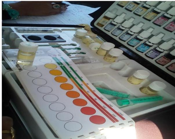
**Figure 18 :** la boîte des réactifs colorimétrique pour l'analyse chimique.
