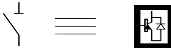
**Fig.(II.6):** Interrupteurs équivalents du filtre actif à source de tension.
