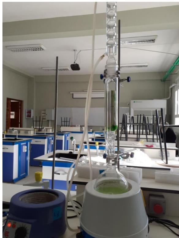
**الوثيقة (13): جهاز السوكسلி المستعمل في الاستخلاص.**
