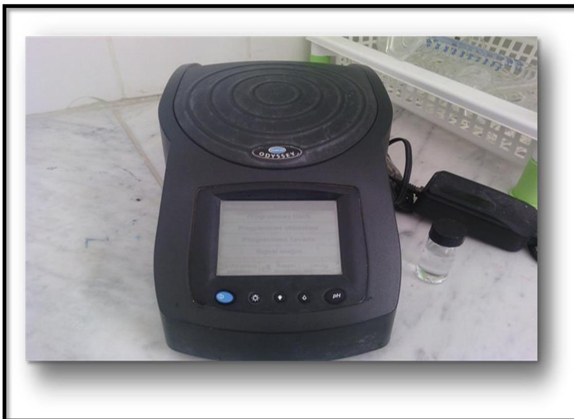
**Figure 10:** Spectrophotomètre UV-Visible (NEZLI N.; CHABBI M., 2018)
