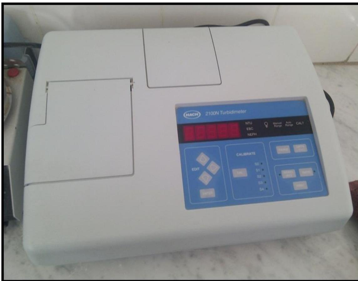
**Figure 9:** Turbidimètre optique et électronique HACH modèle 2100N (NEZLI N.; CHABBI M., 2018)
