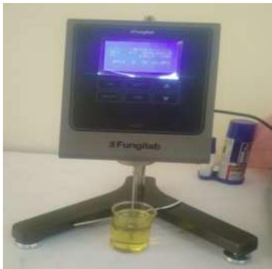
**Figure III-11** : Mesure par viscosimètre
