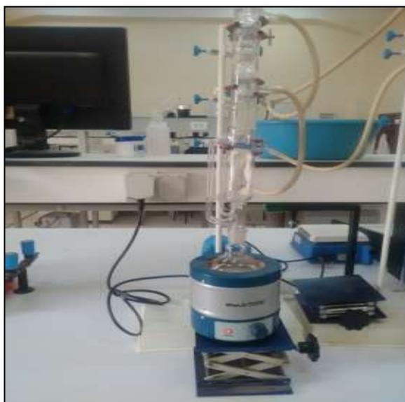
**Figure III-7 : Extracteur soxhlet**
