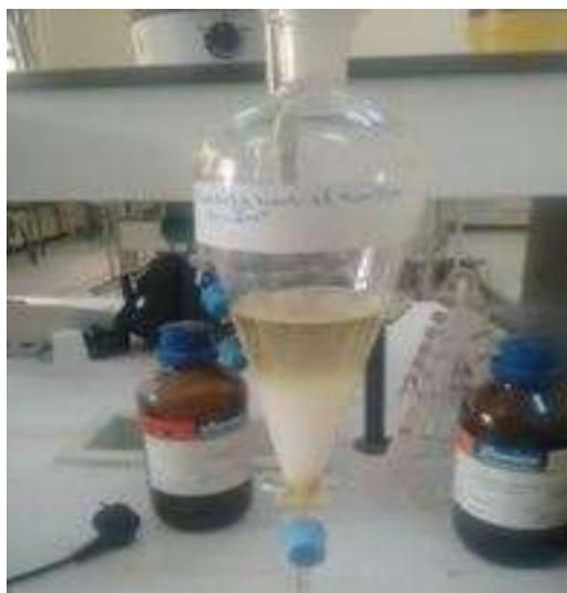
**Figure III-16 :** Photo de lavage du biodiesel.
