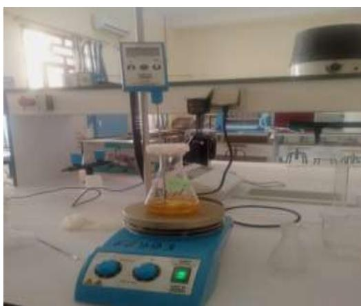
**Figure III.14 :** Photo de réaction de transestérification.
