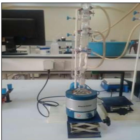
**Figure III-6 :** Montage d'un appareil de Soxhlet
