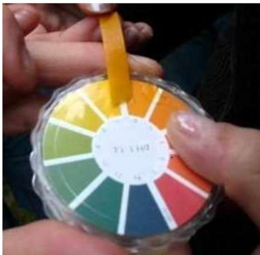
**Figure III-12** : Mesure par papier pH
