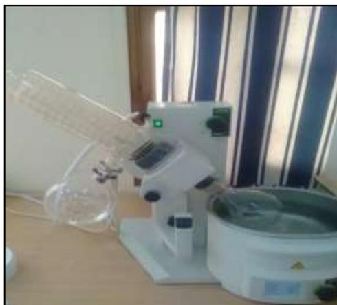
**Figure III-9 :**Appareil rota vapeur
