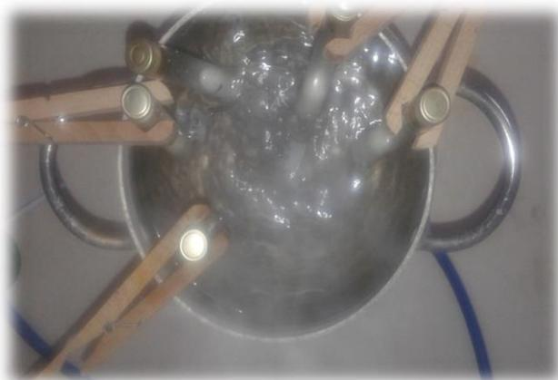
**Figure12.** Test d'ébullition (Photo originale ., 2018).
