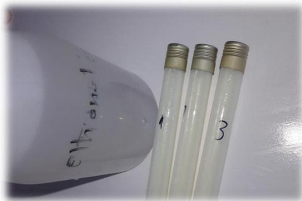
**Figure 11.** Test d'éthanol (Photo originale ., 2018)
