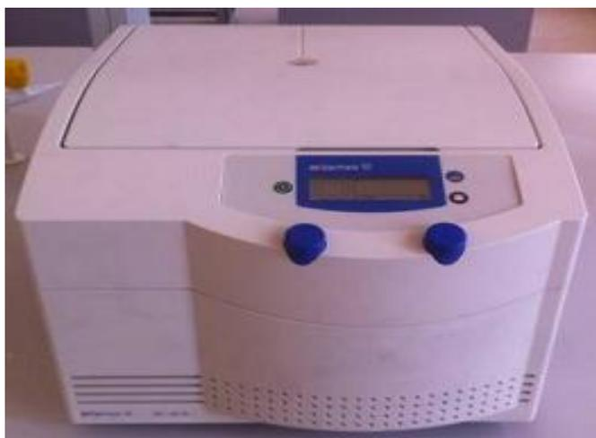
**Figure :** Centrifugeuse horizontale de type SIGMA (photo originale).
