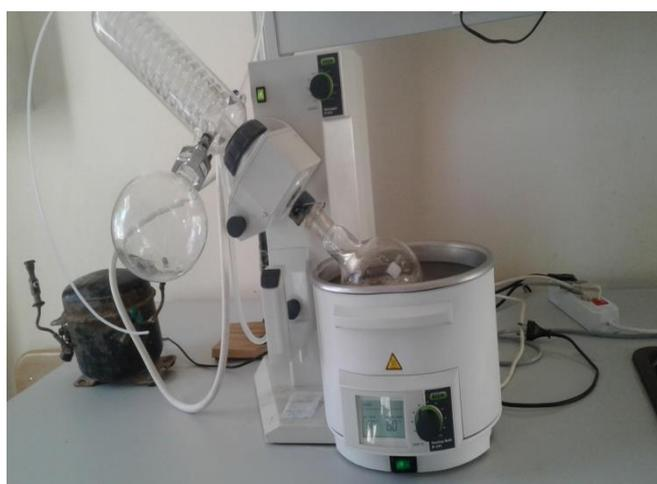
**Figure :** Évaporateur rotatif de type Büchi Rotavapor R-200 (photo originale).
