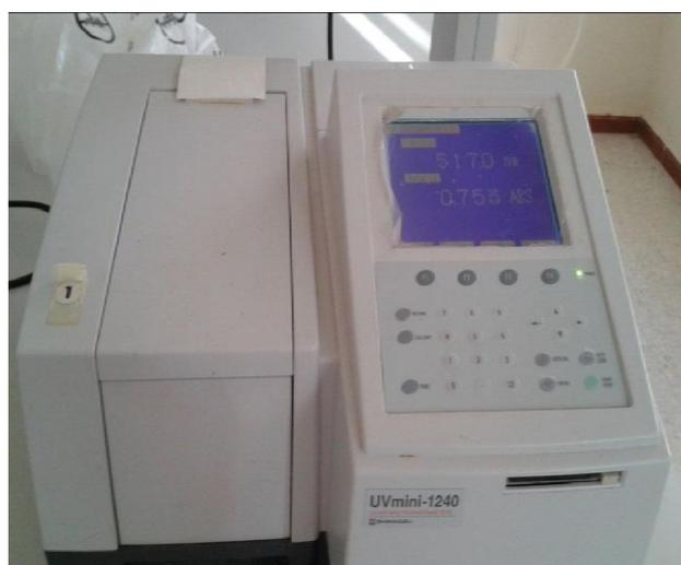
**Figure :** Spectrophotométrie à transmission moléculaire de type UV- VIS -1240 (photo originale).
