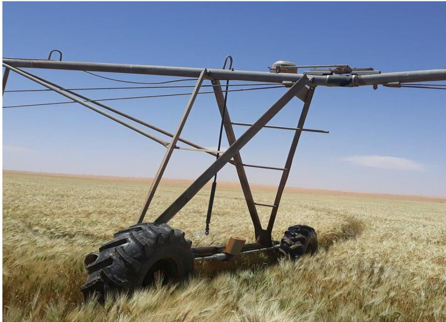
**Figure .I.3: Tour mobile d'un pivot d'irrigation moderne.**
