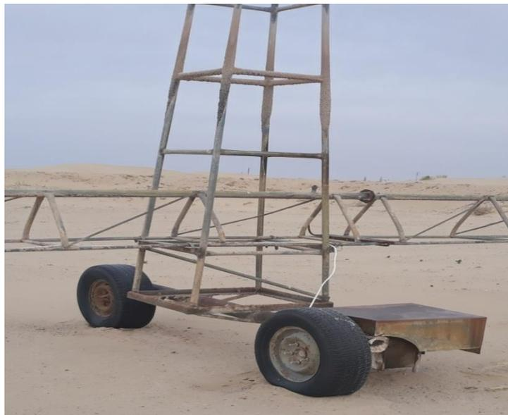
**Figure .I.8: Tour mobile sur pivot d'irrigation traditionnel.**
