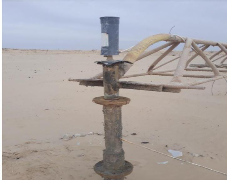
**Figure .I.7: Elément centrale de pivot d'irrigation traditionnel.**
