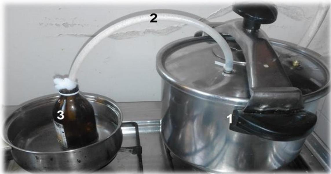
**Figure 12: montage d'alambic** (*Merzougui, 2015 ; R. Bessah, 2015*).
