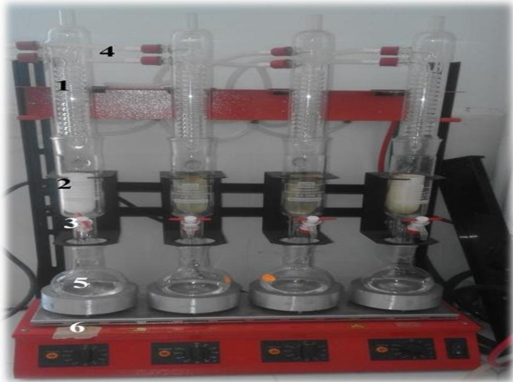
**Figure 13:montage de soxhlet.** (*Merzougui,2015 ; R. Bessah ,2015*).
