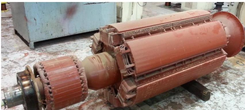
**Figure I .4 :** Rotor à pole saillant [10]
