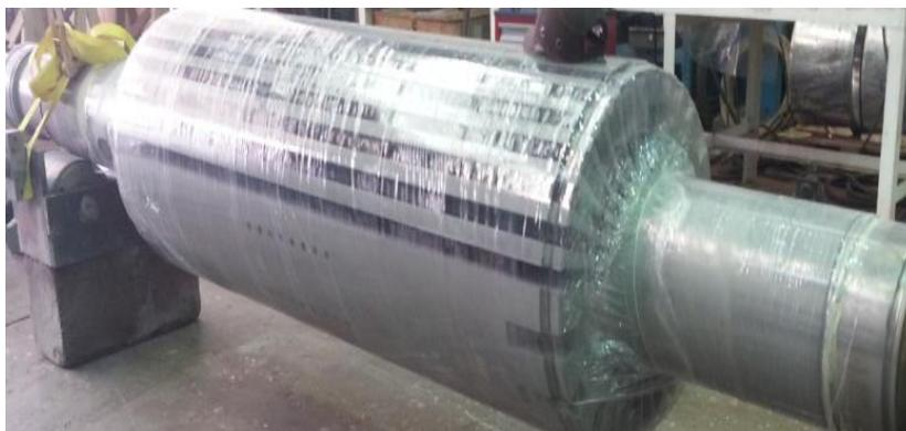
**Figure I.5 :Rotor à pole lisse[6]**
