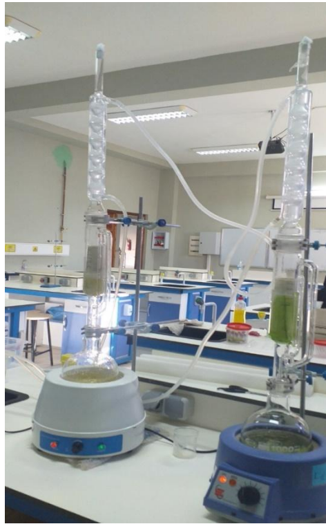
الوثيقة(07): صورة حقيقية توضح مختلف أجزاء جهاز Soxhlet
