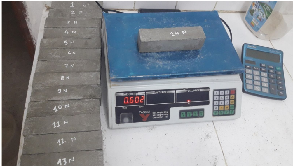
الشكل 26: يوضح عملية ترقيم ووزن العينات
