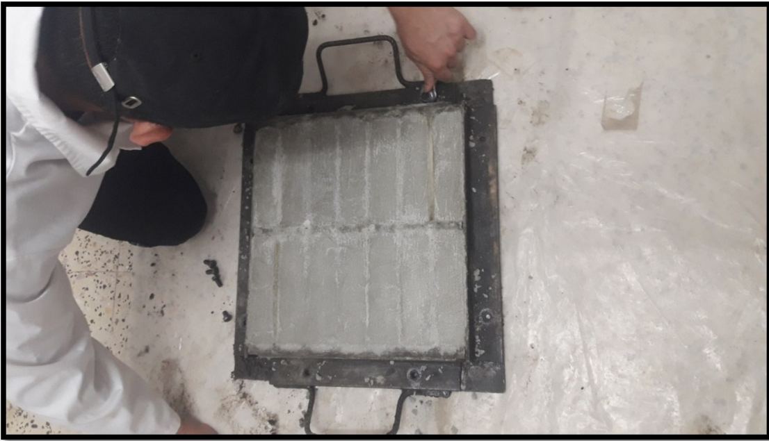
الشكل 25: يوضح عملية إزالة العينة من القالب بعد 24 ساعة
