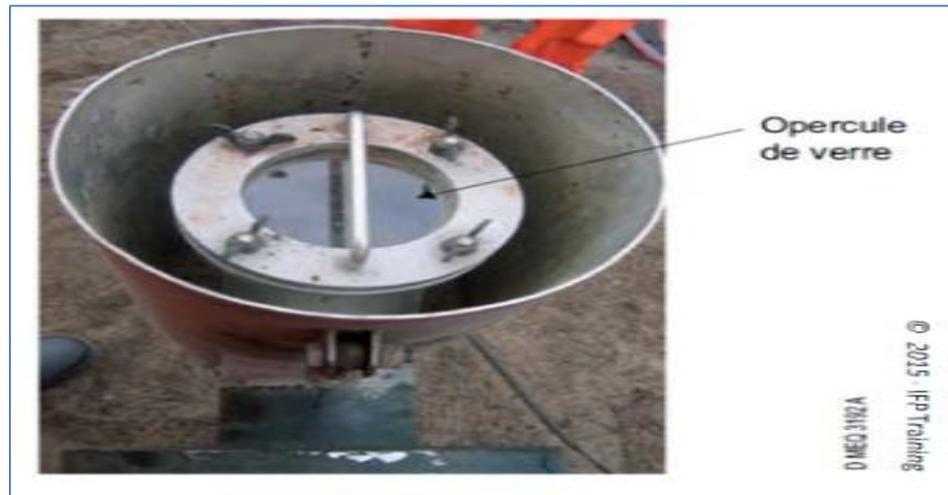
*Figure (III.30): Opercule de verre de boîtier à mousse [4].*
