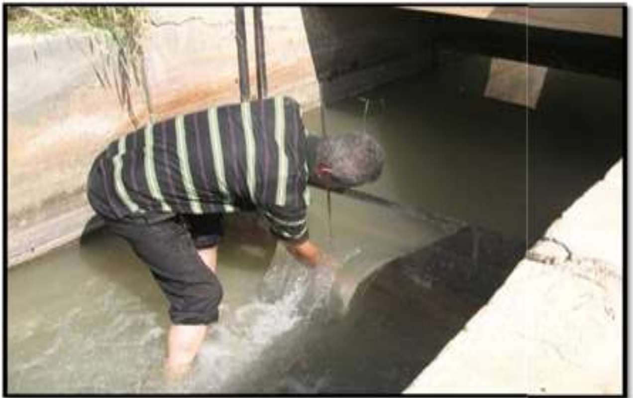
Figure 18: Déversoir triangulaire pour la mesure du débit du canal rive droite
