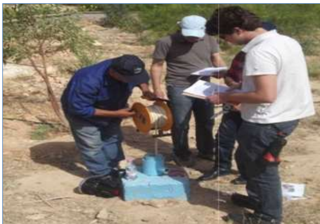
Figure 20: mesure la profondeur de piézomètre
