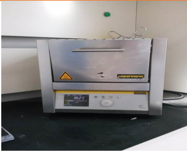
Figure. 8 :four à moufle à 600°C
