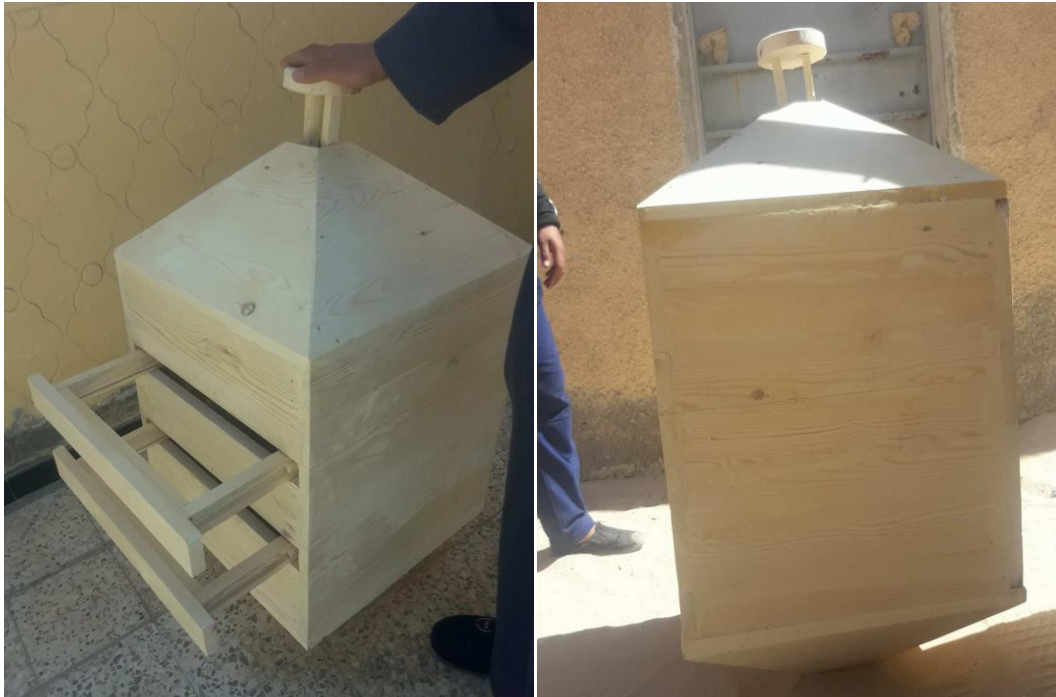
Figure A 1 : la boîte de séchage sans laine de verre et la résine
