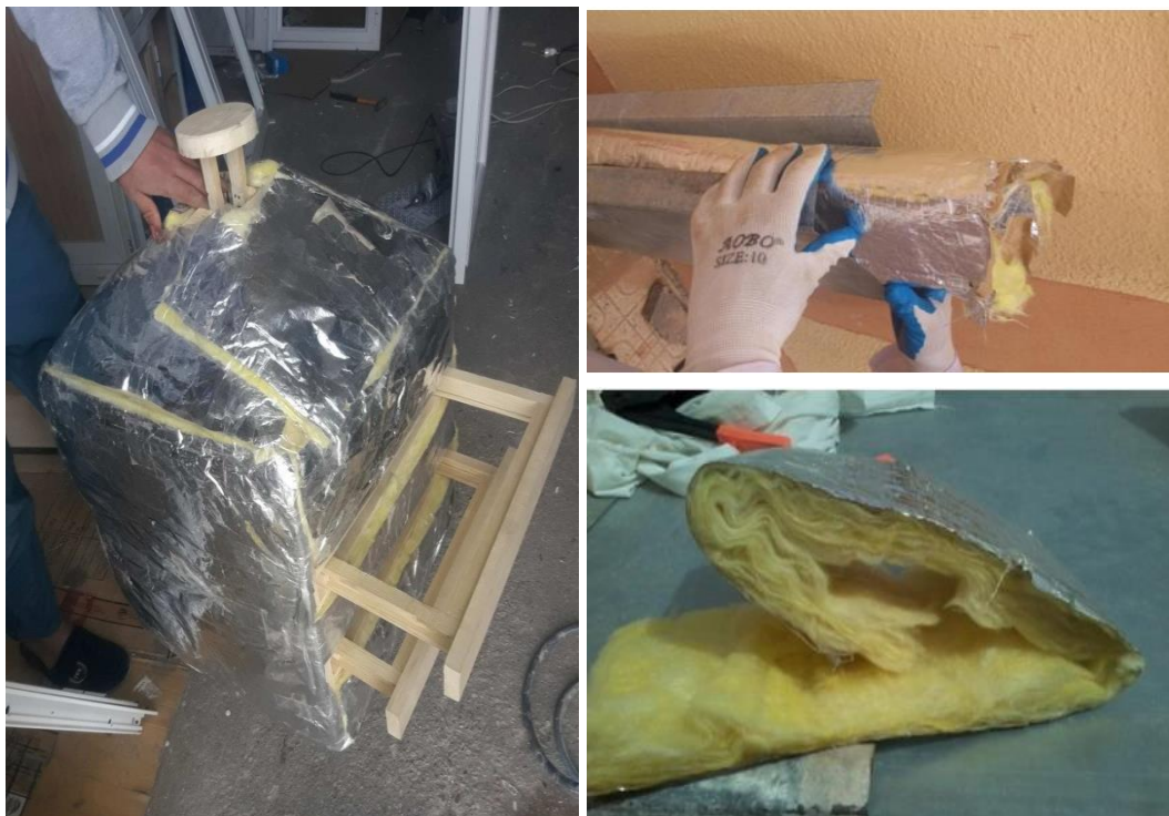
Figure A 2 : la boîte de séchage avec laine de verre
