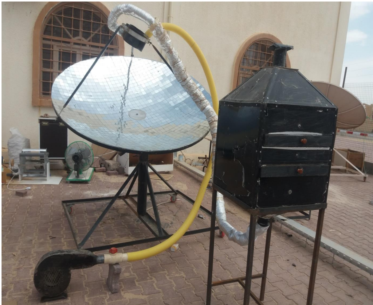
Fig IV.1: Le système utilisé (séchoir solaire indirect forcée à concentrateur parabolique)
