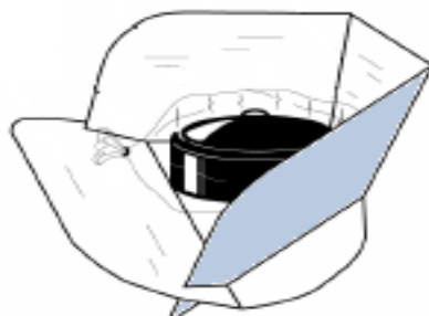
Figure II.1 : Schéma de principe d'un cuiseur à panneaux [6].
