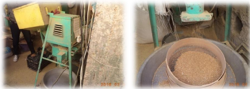
Figure 22 Battage mécanique de quinoa
