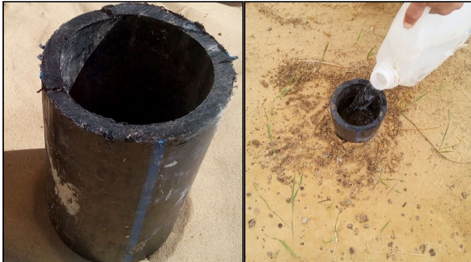
Figure 19 : Tuyau et test du filtration
