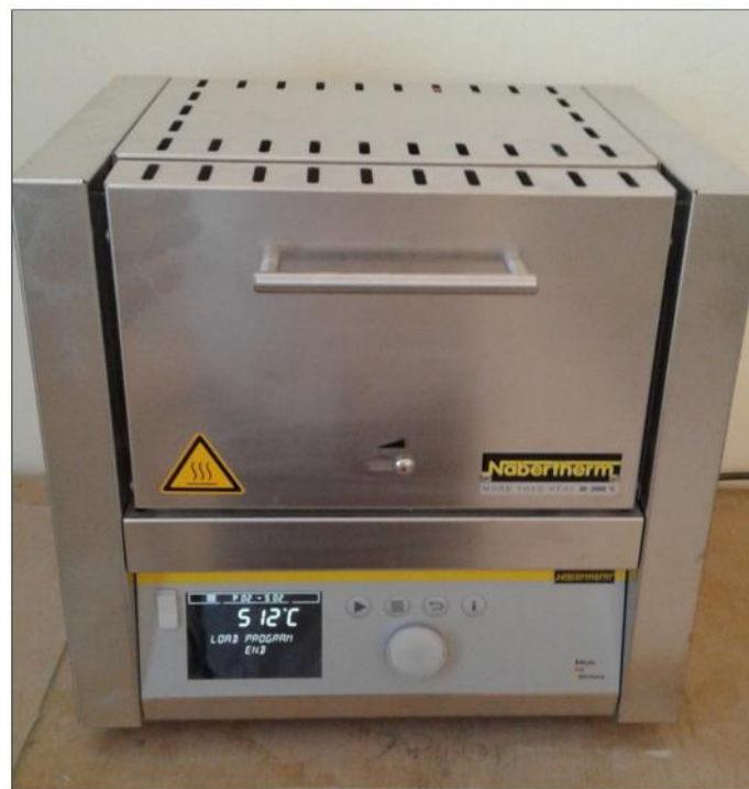
Annexe 02: Figure de four à moufle
