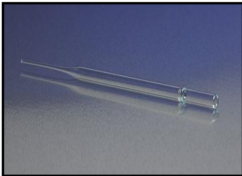
الوثيقة (18) : ماصة باستور الزجاجية المستعملة في صناعة الأنابيب الشعرية. ( حليس، 2012 )
